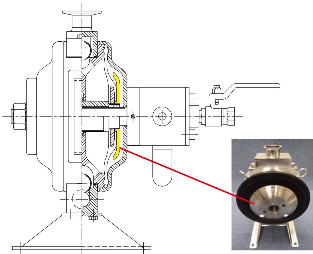
外部（吸込側）からの押込みがかかる場合は、通常仕様では外部圧力にあわせてポンプ自身も作動しないとダイアフラムへ負荷がかかり、損傷の可能性があります。
